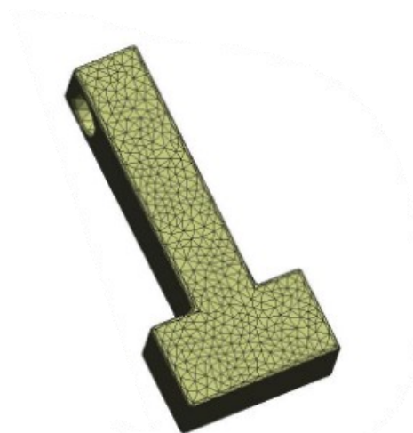
Рис. 3. Конечно-элементная сетка исследуемой модели
