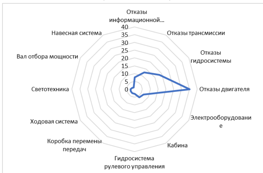
Рис. 1. Распределение основных отказов (%) систем тракторов
