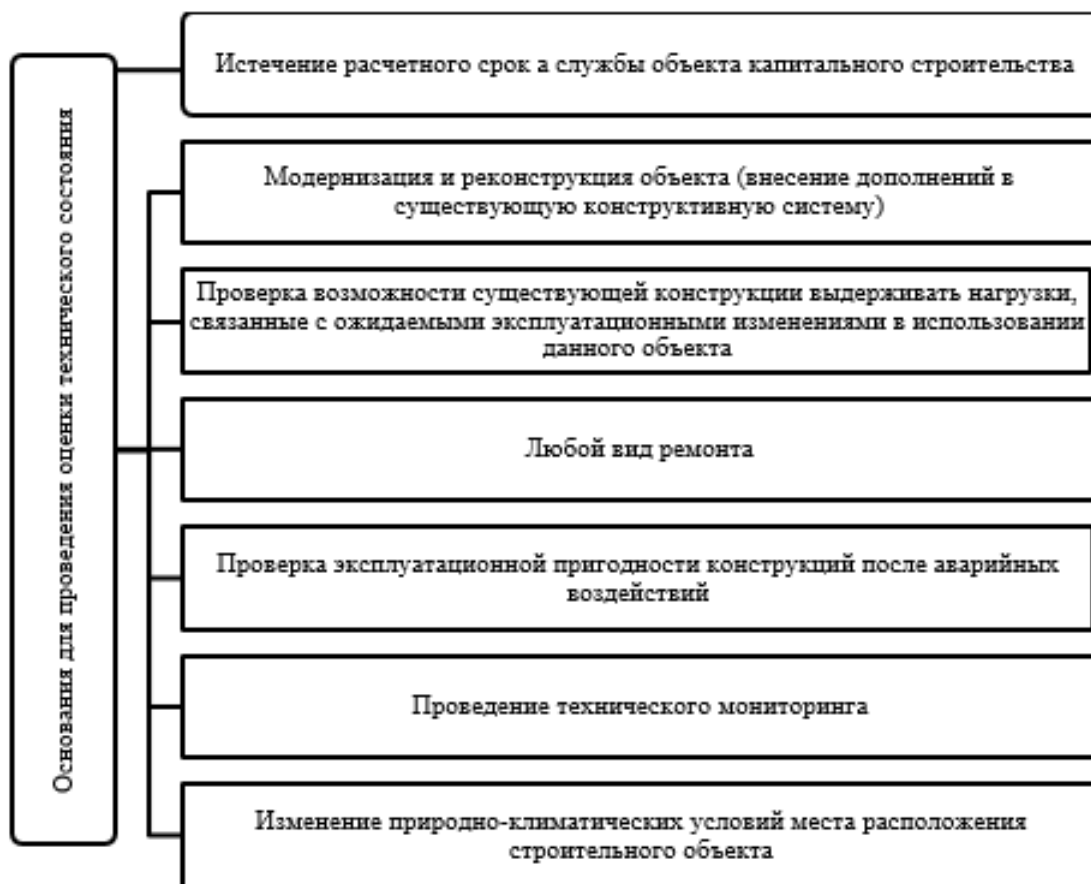
Рисунок 3. Основания для проведения оценки технического состояния
